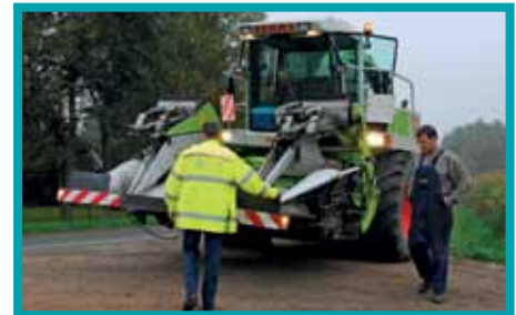
Uitstekende delen die gevaarlijk zijn voor andere weggebruikers, moeten zijn afgeschermd.
