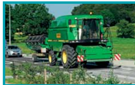
Deze maaidorser kan niet harder dan 30 km/h en moet een bedrijfsrem hebben met een remvertraging van ten minste 2,4 m/s 2 .
