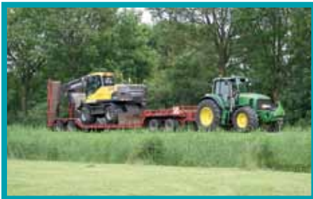
De graafmachine kan niet in delen worden gesplitst en is dus ondeelbare lading.
