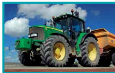
De remvertraging van deze trekker moet minimaal 3,1 m/s 2 bedragen.
