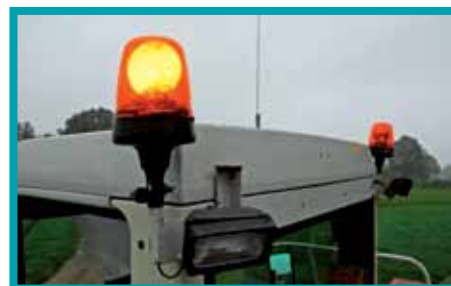
Elk voertuig breder dan 2,60 meter moet een zwaai- of knipperlicht kunnen voeren.
